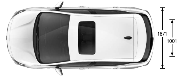
Breite mit eingeklappten Außenspiegeln 1871 mm
