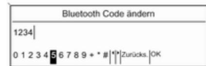
**Bluetooth Code ändern** wählen. Im angezeigten Menü den aktuellen Bluetooth-Code bearbeiten und den geänderten Code mit **OK** bestätigen.
