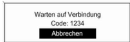
**Gerät zufügen (Freisprechen)** wählen. Der am Mobiltelefon einzugebende Bluetooth-Code wird angezeigt.
