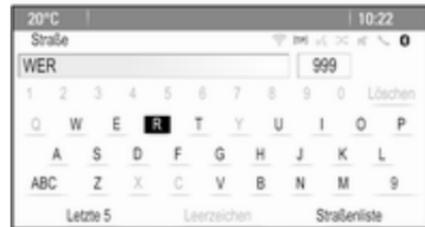
Um die Buchstabenanordnung der Tastatur zu ändern, links die Bildschirmtaste **ABC** auswählen. Die Buchstaben werden in alphabetischer Reihenfolge angeordnet.
