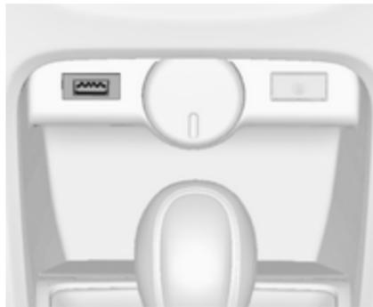
In der Mittelkonsole befindet sich eine USB-Buchse zum Anschluss externer Audiodatenquellen.
