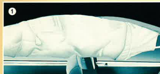
① Für zusätzliche Sicherheit der optionale Kopfairbag zum Schutz bei seitlichem Aufprall.
