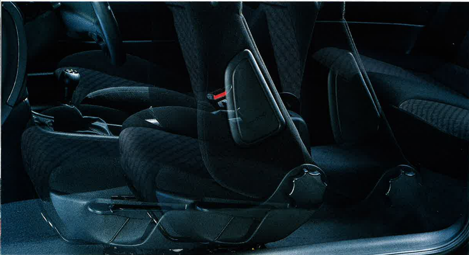
Verschiebbarer Frontsitz Beim 3-Türer erleichtern „Easy Entry“-Vordersitze mit Memory-Funktion den Fondpassagieren das Einsteigen.
