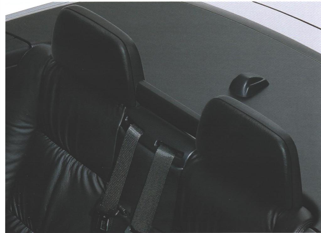
Keine Kompromisse: der massive Überrollbügel mit den zwei integrierten Kopfstützen hinten, hier mit den im 2.0 Turbo serienmäßigen und sonst als Sonderausstattung erhältlichen Polstern.
