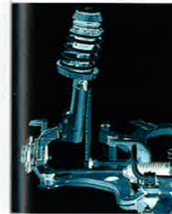
Die Vorderradaufhängung: McPherson-Aluminium-Federbeine mit DSA-Charakteristik für spurtreues Handling und Bremsen in kritischen Situationen.
