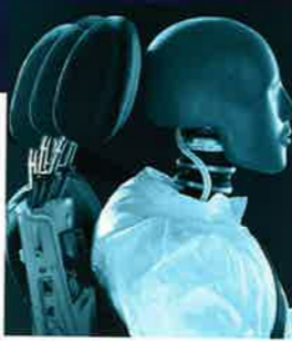
Neueste Sicherheitstechnologie. Die vorderen aktiven Kopfstützen gleiten im Fall eines Heckaufpralls automatisch in Richtung Hinterkopf und vermindern so die Gefahr von Nackenverletzungen.
