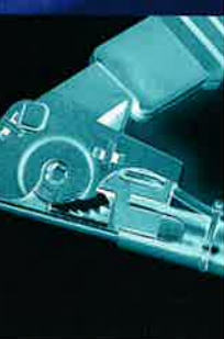
Pyrotechnische Gurtstraffer an den höhenverstellbaren Automatikgurten halten Sie vorn fest im Sitz.
