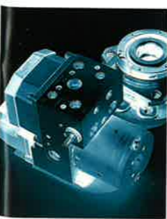
Serienmäßiges 4-Kanal-ABS mit EBV und 4 Scheibenbremsen erhalten die Lenkfähigkeit und reduzieren den Bremsweg. Das Traction Control System TC Plus: verbesserte Antischlupfregelung mit Motor- und Bremsengriff. Für mehr Sicherheit bei allen Fahrbahn-Zuständen. (Serie bei 1.8 16V und 2.0 16V).
