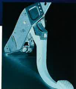
Opel Patent: das PRS-System, das bei einem Frontalaufprall die Pedalbox auskuppelt und so die Beine des Fahrers schützt.
