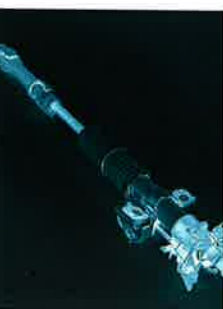
Die Teleskop-Sicherheits-Lenksäule schiebt sich bei einem Aufprall so zusammen, dass die maximale Schutzwirkung des Airbags weitestgehend erhalten bleibt.
