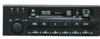
Das CAR 400 von Philips hat eine Ausgangsleistung von 4 x 20 Watt und verfügt z. B. über ein abnehmbares Bedienteil, geschwindigkeitsabhängige Lautstärkeregelung, getrennte Höhen- und Tiefenregelung, automatische Bandsortenwahl, Cassetten-Programm-Suchsystem, Autoreverse, „Dolby B“.
