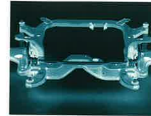
Der Fahrstuhl mit 6 Entkoppelungspunkten optimiert Fahrkomfort und Handling.
