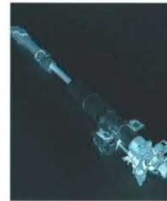
Die Teleskop-Sicherheits-Lenksäule schiebt sich bei einem Aufprall so zusammen, daß die maximale Schutzwirkung des Airbags weitestgehend erhalten bleibt.
