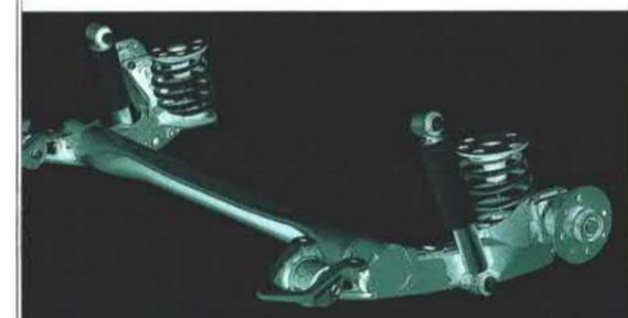
*Die von der Karosserie entkoppelte Hinterachse des neuen DSA-Sicherheitsfahrwerks: weniger Teile, Gewicht und Geräusche. Plus hervorragendes Fahrverhalten, hoher Fahrkomfort, präziseres Handling.*
