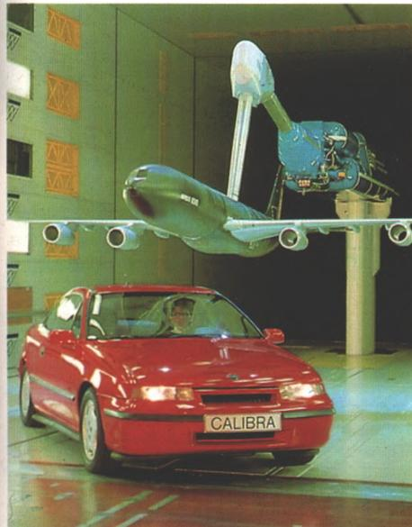
Wo der Airbus erprobt wird, testete auch Opel den neuen Calibra in den modernsten Windkanälen (Seite 22)
