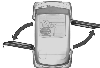
Das Fahrzeug hat zwei Türen mit unterschiedlicher Öffnungsrichtung.
