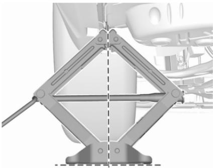
4. Wagenheber auf die erforderliche Höhe einstellen. Direkt unter dem Aufnahmepunkt so positionieren, dass er nicht abrutschen kann.
