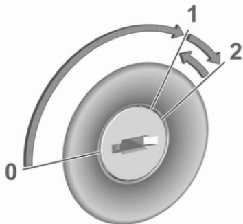
Den Schlüssel in Stellung 1 drehen, um die Lenkradsperre freizugeben.
