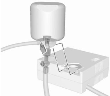
Typ B: Den Kompressorluftschlauch an den Anschluss an der Dichtmittelflasche schrauben.
