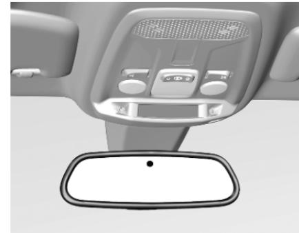
Beim Fahren im Dunkeln wird die Blendwirkung nachfolgender Fahrzeuge automatisch reduziert.
