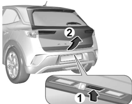
1. Die Heckklappentaste drücken oder
