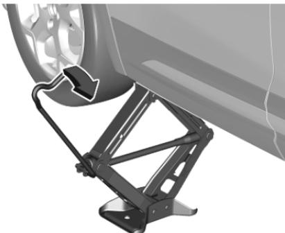
Radschlüssel bei korrekt ausgerichtetem Wagenheber drehen, bis das Rad vom Boden abhebt.
