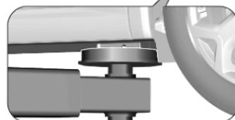
Die Position der hinteren Arme der Hebebühne befindet sich mittig unter den entsprechenden Wagenheberaufnahmen.
