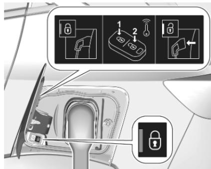
Nach dem Beginn des Ladevorgangs wird der Fahrzeugstecker am Ladeanschluss verriegelt und kann während des aktiven Ladens nicht getrennt werden.
