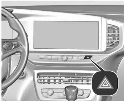
Wird durch Drücken von  $\triangle$  bedient.
