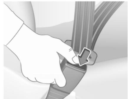
Zum Lösen des Sicherheitsgurts die rote Taste am Gurtgeschloss drücken und den Sicherheitsgurt zurückführen.
