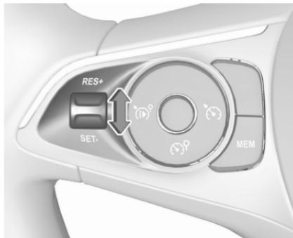
Bis zur gewünschten Geschwindigkeit beschleunigen und das Daumenräddchen kurz auf **SET/-** drehen. Die aktuelle Geschwindigkeit wird gespeichert und beibehalten. Gaspedal kann gelöst werden.
