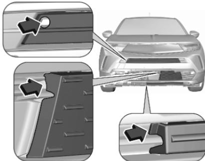
Die Kälteschutzabdeckungen entfernen. Dazu diese an den angegebenen Stellen vorsichtig herausziehen.
