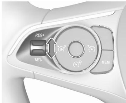
Die voreingestellte Höchstgeschwindigkeit kann durch Drücken des Daumenräddchens auf **RES/+** erhöht bzw. auf **SET/-** gesenkt werden. Daumenräddchen mehrmals kurz schieben, um die Geschwindigkeit in kleinen Schritten zu ändern, länger schieben, um sie in großen Schritten zu ändern.
