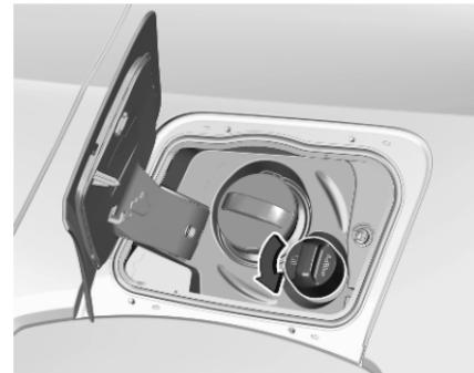
4. Die Schutzkappe vom Einfüllstutzen abschrauben.
