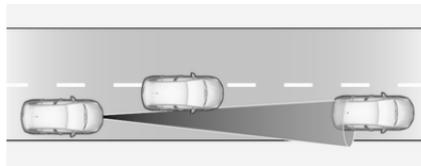
Wechselt ein anderes Fahrzeug auf die von Ihnen verwendet Spur, berücksichtigt der adaptive Geschwindigkeitsregler das Fahrzeug erst nach dem vollständigen Spurwechsel. Darauf gefasst sein, bei Bedarf das Bremspedal zu betätigen.
