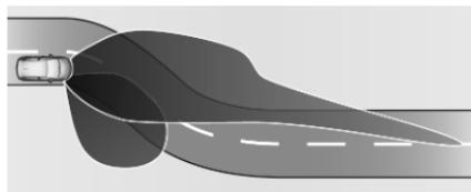
Je nach Lenkwinkel und Geschwindigkeit werden spezielle LED zusätzlich eingeschaltet, um in Kurven das Scheinwerferlicht zu verbessern.
