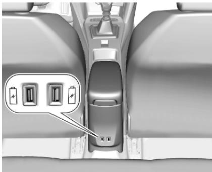
Der Schlitz unter den USB-Anschlüssen an der Rückseite des Stauraums dient dem Befestigen eines Zubehör-Getränkehalters.
