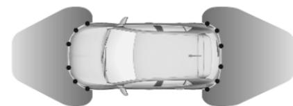
Die erweiterte Einparkhilfe ist immer mit der Front-Heck-Einparkhilfe kombiniert.
