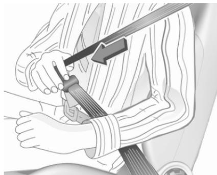
Den Sicherheitsgurt aus dem Aufroller herausziehen, unverdreht über den Körper führen und die Schlosszunge in das Gurtgeschloss einstecken, bis sie einrastet. Sicherstellen, dass der Sicherheitsgurt über die Schulter verläuft und während der Fahrt eng am Körper anliegt.
