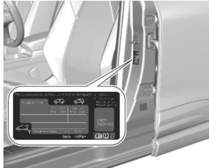
Das Reifendruckhinweisschild an der linken B-Säule gibt die Originalreifen und die entsprechenden Reifendrücke an.
