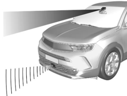
Das System erkennt vor Ihnen befindliche Fußgänger mithilfe der Frontkamera in der Windschutzscheibe und, je nach Fahrzeugkonfiguration, einer Radareinheit im vorderen Stoßfänger.
