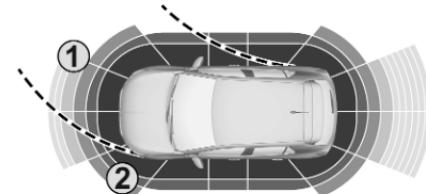
Wenn sich das Hindernis (1) in der Fahrspur des Fahrzeugs befindet und möglicherweise eine Kollision bevorsteht, ertönt ein akustisches Warnsignal.
