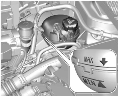
Bei kaltem Kühlsystem muss der Külmittelspiegel über der Markierung **MIN** liegen. Bei zu niedrigem Füllstand auffüllen.
