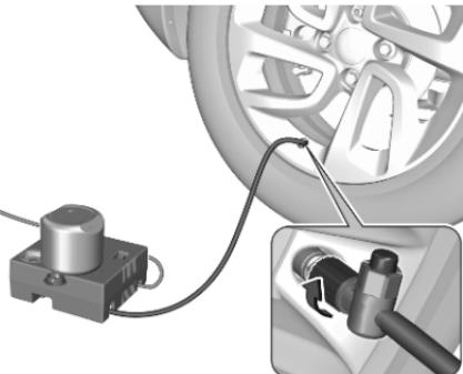
9. Den Einfüllschlauch am Reifenventil anschrauben.
