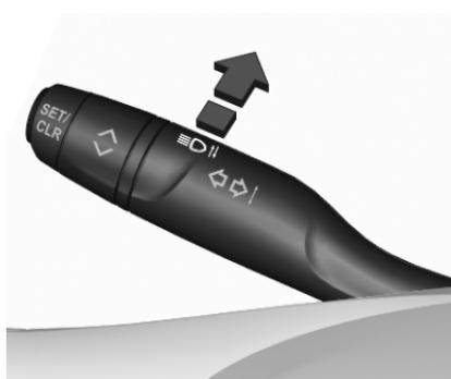
Durch Drücken wird von Abblend- auf Fernlicht umgeschaltet.
