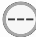
Wenn eine Geschwindigkeitsbegrenzung erkannt wird und das Fahrzeug diese zum ersten Mal um mehr als 5 km/h überschreitet, wird die Geschwindigkeit angezeigt und blinkt etwa 10 Sekunden lang.
