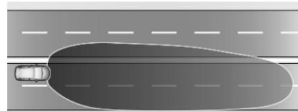
Wird bei einer Geschwindigkeit über 105 km/h automatisch aktiviert. Die Leuchtweite wird an die höhere Autobahngeschwindigkeit angepasst. Ohne Gegenverkehr wird die Sicht auf der Fahrzeugseite erhöht. Bei vorausfahrenden Fahrzeugen bzw. beim Überholen wird der andere Verkehrsteilnehmer weniger geblendet.
