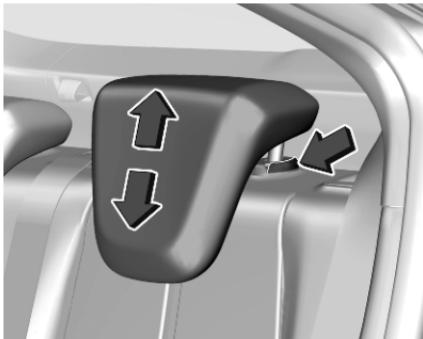
Kopfstütze nach oben ziehen bzw. Rastfedern durch Drücken entriegeln und Kopfstütze nach unten schieben.
