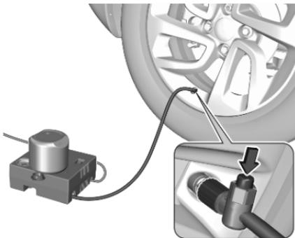
Zu hohen Reifendruck über die Taste am Luftschlauch korrigieren.
