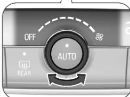
Luftstrom durch Drehen des Drehknopfs auf die gewünschte Geschwindigkeit einstellen. Die Gebläsedrehzahl kann auch im Menü Klimatisierungseinstellungen geändert werden. Zum Öffnen des Menüs auf **MENU** drücken.
