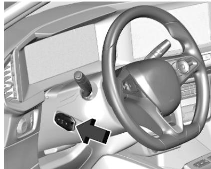
Elektronischen Schlüssel wie in der Abbildung gezeigt an die Markierung an der Lenksäulenabdeckung halten.
