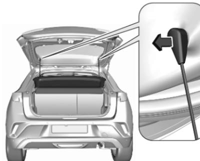
Haltebänder von Heckklappe lösen.
