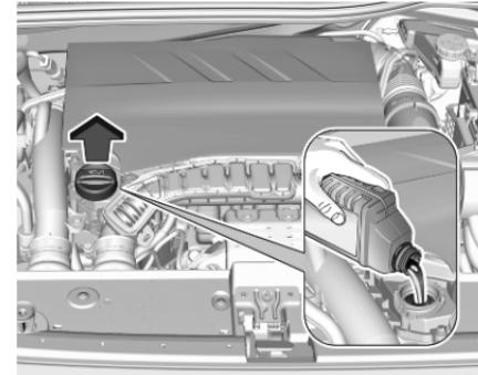
Der Motorölstand darf die obere Marke **MAX** am Messstab nicht überschreiten.
