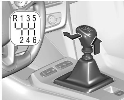
Zum Einlegen des Rückwärtsgangs das Kupplungspedal betätigen, den Ring unter dem Wählhebelknopf nach oben ziehen und den Wählhebel nach links vorne bewegen.
