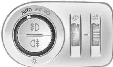
Bei aktiverter automatischer Lichtsteuerung schaltet das System abhängig von den äußereren Lichtverhältnissen und den Informationen des Wischersystems automatisch zwischen Tagfahrlicht und Scheinwerfern um.
