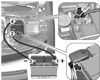
Reihenfolge für das Anschließen der Kabel:
