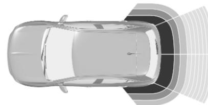
Außerdem wird der Abstand zu Hindernissen hinter dem Fahrzeug durch sich ändernde Abstandslinien im Info-Display angezeigt ▷ 81. Bei einem sehr geringen Abstand wird das Warnsymbol  $\Delta$  angezeigt.
