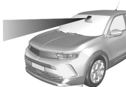
Die Spurverlassenswarnung unterstützt den Fahrer beim Vermeiden eines unbeabsichtigten Verlassens der Fahrspur. Die Frontkamera überwacht Straßenränder sowie die Spurmarkierungen, zwischen denen das Fahrzeug fährt. Wenn sich das Fahrzeug dem Fahrbahnrand oder einer Fahrspurmarkierung nähert, warnt das System den Fahrer.
