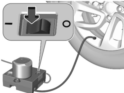
12. Wippschalter auf dem Kompressor auf I stellen. Der Reifen wird mit Dichtmittel gefüllt.
