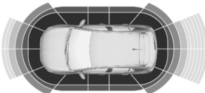
Diese Funktion warnt den Fahrer durch Anzeigen von Hinweisen, wenn Hindernisse seitlich neben dem Fahrzeug erkannt werden. Wenn sich das Hindernis neben dem Fahrzeug und in der Fahrspur befindet und möglicherweise eine Kollision bevorsteht, ertönt ein akustisches Warnsignal. Hindernisse seitlich neben dem Fahrzeug werden nur berücksichtigt, wenn sie zuvor von den Parksenso- ren erkannt und vom System gespei- chert wurden.
