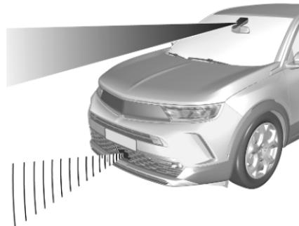
Die Auffahrwarnung erkennt Fahrzeuge, die sich in der gleichen Fahrspur vor dem eigenen Fahrzeug befinden, mithilfe der Frontkamera in der Windschutzscheibe und je nach Fahrzeugkonfiguration mit einer Radareinheit im Frontstoßfänger.
