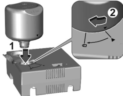
5. Typ A: Zunächst die Flasche mit dem Dichtmittel in den Kompressor einsetzen und die Dreiecksymbole ausrichten. Dann die Flasche mit dem Dichtmittel nach unten drücken und in die Verriegelungsposition drehen.
