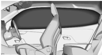
Der aufgeblähte Airbag dämpft den Aufprall, wodurch die Verletzungsgefahr für den Kopf bei einem Seitenauftreff deutlich verringert wird.
