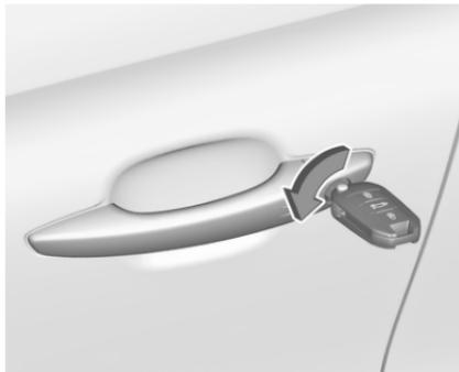
Die linke Vordertür durch Einsetzen und Drehen des Schlüssels im Schließzylinder von Hand entriegeln.
