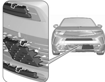
2. Von außen den oberen Teil der Kälteschutzabdeckungen gegen die Lamellen des Gitters drücken.
