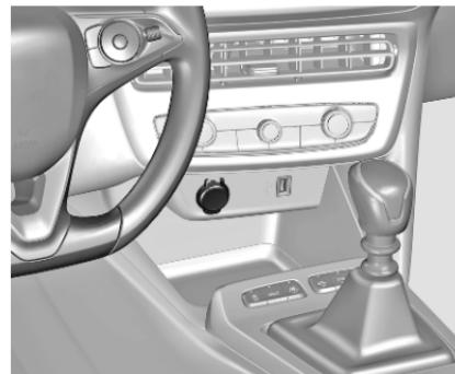
Die maximale Leistungsaufnahme darf 120 W nicht überschreiten.
