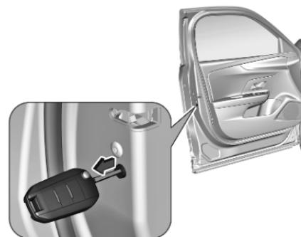
Zum Verriegeln der anderen Türen die Hintertüren öffnen. Sicherstellen, dass die Kindersicherung deaktiviert ist.
