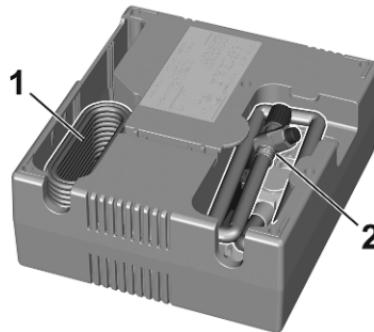
3. Stromkabel (1) und Luftschlauch (2) aus den Staufächern auf der Unterseite des Kompressors herausnehmen.
