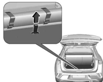
Die Kofferraumbodenabdeckung kann angehoben und ausgebaut werden. Die Laderaumabdeckung an der Aussparung anheben und dann abnehmen.
