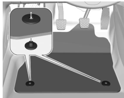
2. Schlitze in der Matte wie gezeigt an den Haltern ausrichten.
