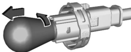
2. Lampe leicht nach unten drücken, linksherum drehen und aus der Fassung ziehen.
