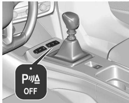
Beim Ausrücken des Rückwärtsgangs wird das System ausgeschaltet.
