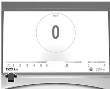
Die erfasste Gesamtfahrstrecke wird in km angezeigt.
