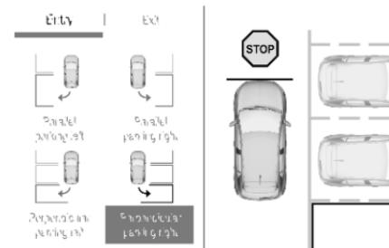
Wird eine freie Parklücke erkannt, wird im Info-Display eine optische Rückmeldung gegeben und es ertönt ein Signalton. Anhalten, Rückwärtsgang einlegen, Lenkrad loslassen und mit maximal 7 km/h fahren.
