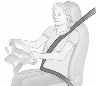
Bei starker Beschleunigung oder Verzögerung des Fahrzeugs blockieren die Sicherheitsgurte, um die Insassen in ihrer Sitzposition zu halten. Dies verringert die Verletzungsgefahr drastisch.
