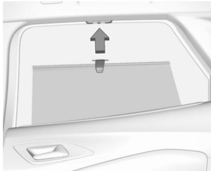
Um die Sonneneinstrahlung auf die Rücksitze zu reduzieren, das Sonnenrollo am Griff hochziehen und oben am Türrahmen einhängen.
