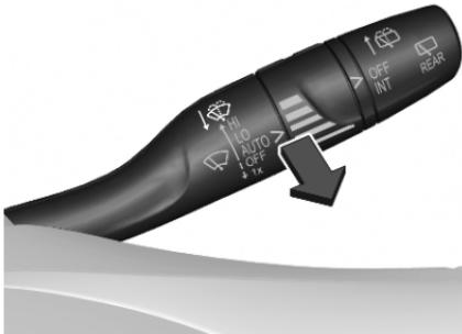
Hebel ziehen. Waschflüssigkeit spritzt auf die Windschutzscheibe und der Wischer wird für einige Wischbewegungen eingeschaltet.
