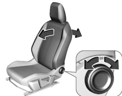
Handrad drehen. Zum Einstellen Rückenlehne entlasten.
