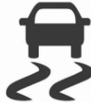
Die elektronische Stabilitätsregelung und die Traktionskontrolle sind nach jedem Motorstart funktionsfähig, sobald die Kontrollleuchte
