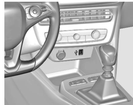
Der USB-Anschluss liefert eine Spannung von 5 V.
