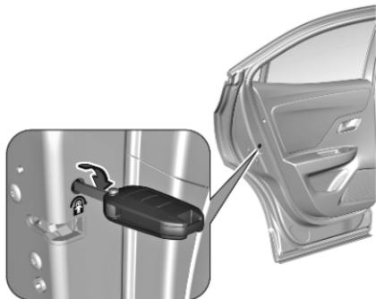
rote Kindersicherung in der hinteren Tür mit einem Schlüssel in Richtung Fahrzeuginnenraum in die waagerechte Stellung drehen. Die Tür lässt sich dann von innen nicht öffnen.
