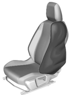
Der aufgeblähte Airbag dämpft den Aufprall, wodurch die Verletzungsgefahr für Oberkörper und Becken bei einem Seitenauftprall deutlich verringert wird.
