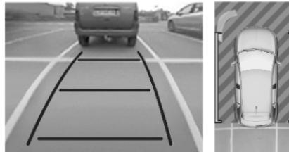
Der Bildschirm im Info-Display ist zweigeteilt. Rechts erscheint ein Bild des Fahrzeugs von oben, links die Ansicht von hinten. Bei Fahrzeugen, die mit Ultraschall-Einparksensoren ausgestattet sind, ergänzen diese die Informationen zur Ansicht des Fahrzeugs von oben.
