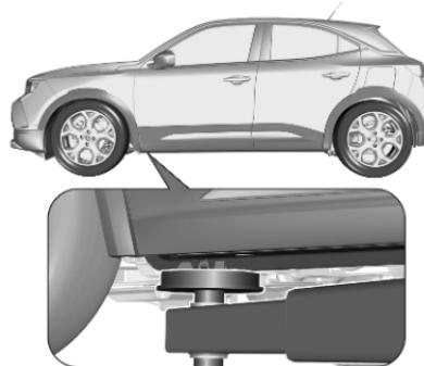
Die Position der vorderen Arme der Hebebühne befindet sich mittig unter den entsprechenden Wagenheberaufnahmen.
