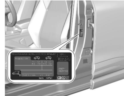
Das Reifendruckhinweisschild an der linken B-Säule gibt die Originalreifen und die entsprechenden Reifendrücke an.
