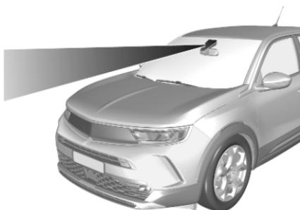
Die Spurverlassenswarnung unterstützt den Fahrer beim Vermeiden eines unbeabsichtigten Verlassens der Fahrspur. Die Frontkamera überwacht Straßenränder sowie die Spurmarkierungen, zwischen denen das Fahrzeug fährt. Wenn das Fahrzeug den Fahrbahnrand oder eine Fahrspurmarkierung überquert, warnt das System den Fahrer.
