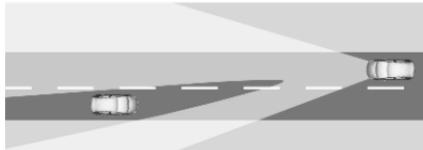
Jede LED auf der rechten bzw. linken Seite wird entsprechend der Verkehrslage speziell zu- oder ausgeschaltet. Das sorgt für die bestmögliche Lichtverteilung, ohne dass Verkehrsteilnehmer geblendet werden.
