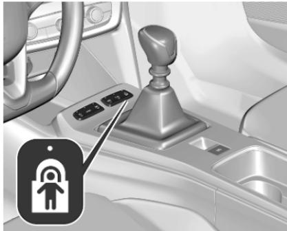
drücken. Die LED in der Taste leuchtet auf und eine Bestätigungsmeldung wird angezeigt. Diese LED leuchtet, bis die Kindersicherung wieder ausgeschaltet wird.
