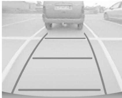
Auf dem Bildschirm wird der Bereich hinter dem Fahrzeug angezeigt. Die senkrechten Linien zeigen die Fahrzeugbreite bei ausgeklappten Seitenspiegeln an. Die Richtung der Linien ändert sich mit der Lenkradstellung.
