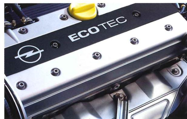
*Der 16V-ECOTEC-Motor mit 100 kW (136 PS) zeichnet sich aus durch exzellente Fahrleistungen und sparsamen Verbrauch. Eine von insgesamt vier Motor-Varianten des Opel Calibra.*
