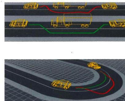
Mit dem elektronisch gesteuerten Anti-Blockier-System (ABS) bleibt die Lenkfähigkeit auch bei Vollbremsung erhalten. Serienmäßig in vielen Opel Pkw's.
