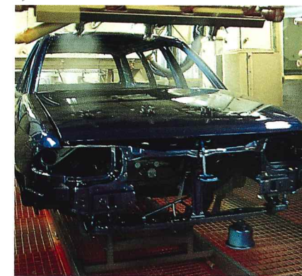
Umweltfreundliche Lackierstraßen bei Opel. Sie verwenden nur noch geringe Mengen organischer Lösungsmittel.
