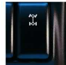
Eine von vielen Innovationen im Frontera. Das No-Stop-Allradsystem NSA. Elektronisches Umschalten auf 4x4- oder Normal-Antrieb bei Geschwindigkeiten bis 100 km/h.
