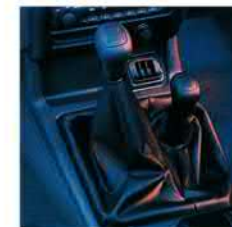
Zuschaltbare Geländeuntersetzung für maximale Durchzugskraft bei extrem niedriger Geschwindigkeit.
