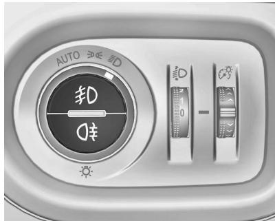
Wird durch Drücken von  $\mathbb{D}$  bedient. Der Lichtschalter in Position **AUTO**: wenn die Nebelscheinwerfer eingeschaltet werden, schalten sich automatisch auch die Scheinwerfer ein.
