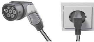
Die Hochvoltbatterie des Fahrzeugs kann an einer Haushaltssteckdose geladen werden. Das Kabel am Ladeanschluss des Fahrzeugs und an der Haushaltssteckdose anschließen. Bei einer Ladeleistung von 1,8 kW dauert der Ladevorgang ungefähr 30 Stunden.
