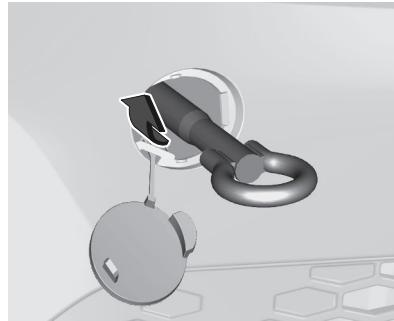
Abschleppöse bis zum Anschlag in waagerechter Stellung einschrauben. Die Abschleppstange an der Abschleppöse befestigen. Die Abschleppöse darf nur zum Abschleppen und nicht zum Bergen des Fahrzeugs verwendet werden. Die Zündung einschalten, um den Betrieb von Bremsleuchten, Hupe und Scheibenwischer zu ermöglichen und, je nach Version, die Lenkradsperrre zu lösen.
