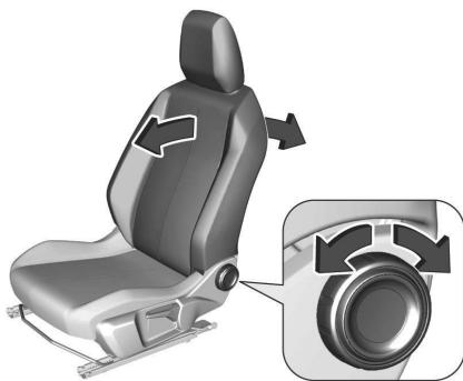
Handrad drehen. Zum Einstellen Rückenlehne entlasten.
