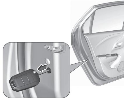
Zum Verriegeln der anderen Türen die Hintertüren öffnen. Sicherstellen, dass die Kindersicherung deaktiviert ist. Schlüssel vorsichtig einstecken und ohne zu drehen zur Innenseite der Tür bewegen.
