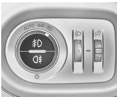
Wird durch Drücken von  $\mathbb{D}$  bedient. Der Lichtschalter in Position **AUTO**: wenn die Nebelrückleuchten eingeschaltet werden, schalten sich automatisch auch die Rückleuchten ein. Lichtschalter in Stellung  $\mathbb{D}$ : Die Nebelschlussleuchte kann nur gemeinsam mit den Nebelscheinwerfern eingeschaltet werden. Die Nebelschlussleuchte wird deaktiviert, wenn ein Stecker an der Anhängersteckdose angeschlossen wird.
