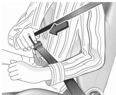
Den Gurt aus dem Aufroller herausziehen, unverdreht über den Körper legen und die Schlosszunge in das Gurtschloss einstecken, bis sie einrastet. Sicherstellen, dass der Sicherheitsgurt über die Schulter verläuft und während der Fahrt eng am Körper anliegt.
