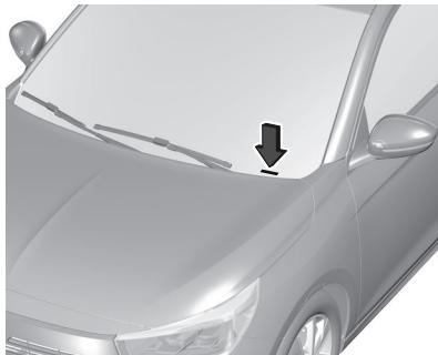
Die Fahrzeug-Identifizierungsnummer kann in der Instrumententafel, durch die Windschutzscheibe sichtbar, oder im Motorraum am rechten Karosserieblech eingestanzt sein.
