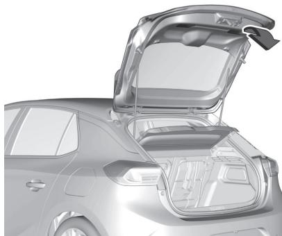
Griff auf der Innenseite verwenden. Beim Schließen nicht auf das Touchpad drücken, da die Heckklappe dadurch wieder geöffnet wird.
