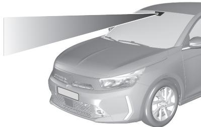
Die Spurverlassenswarnung unterstützt den Fahrer beim Vermeiden eines unbeabsichtigten Verlassens der Fahrspur. Die Frontkamera überwacht Straßenränder sowie die Spurmarkierungen, zwischen denen das Fahrzeug fährt. Wenn das Fahrzeug einen Fahrbahnrand oder eine Fahrbahnmarkierung überfährt, warnt das System den Fahrer. Ein unbeabsichtigtes Verlassen der Fahrspur wird vom System nicht angenommen, wenn die Blinker betätigt
