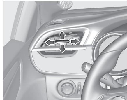
Richtung des Luftstroms durch Kippen und Schwenken der Lamellen einstellen.
