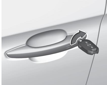
Die Vordertür durch Einsetzen und Drehen des Schlüssels im Schließzylinder von Hand verriegeln.
