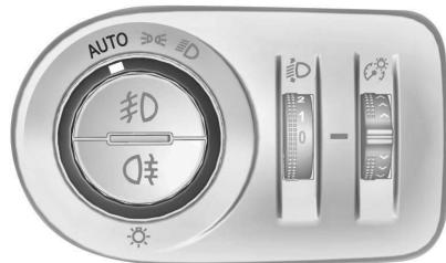
Bei aktivierter automatischer Lichtsteuerung schaltet das System abhängig von den äußereren Lichtverhältnissen und den Informationen des Wischersystems automatisch zwischen Tagfahrlicht und Scheinwerfern um.
