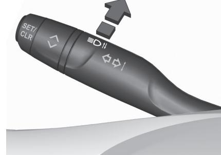
Durch Drücken wird von Abblend- auf Fernlicht umgeschaltet.
