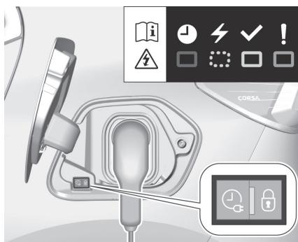
Der Beginn des Ladens wird durch eine grün blinkende Statusanzeige am Ladeanschluss und am Kontrollgerät des Ladekabels (sofern verfügbar) angezeigt.
