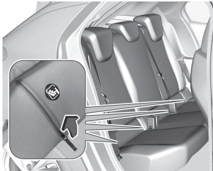
Für das Fahrzeug zugelassene ISOFIX-Kinderrückhaltesysteme an den ISOFIX-Befestigungen befestigen. Die speziellen Positionen für ISOFIX-Kindersicherheitssysteme sind in der [seite34](#) gekennzeichnet.
