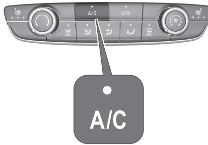
A/C drücken, um die Kühlung einzuschalten. Die LED in der Taste leuchtet auf, um die Aktivierung anzuzeigen. Die Kühlung funktioniert nur bei laufendem Motor und eingeschaltetem Gebläse.
