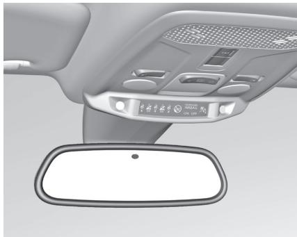
Beim Fahren im Dunkeln wird die Blendwirkung nachfolgender Fahrzeuge automatisch reduziert.
