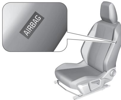
Das Seiten-Airbagsystem besteht aus einem Airbag in jeder Vordersitzlehne. Diese Stellen sind mit dem Wort **AIRBAG** gekennzeichnet. Das Seiten-Airbag-System wird bei einem Seitenauftprall ab einer bestimmten Unfallschwere ausgelöst. Die Zündung muss eingeschaltet sein.
