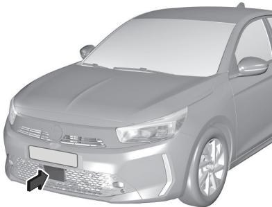
Die Radareinheit befindet sich in der Mitte des Frontstoßfängers.
