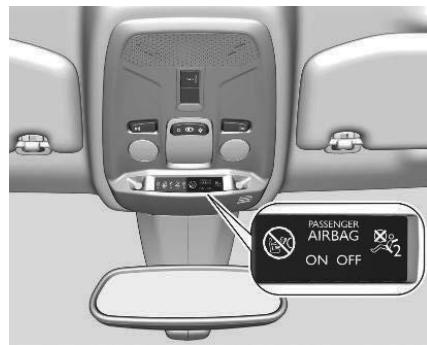
Wenn die Kontrollleuchte ON nach Einschalten der Zündung für ca. 60 Sekunden aufleuchtet, löst der Beifahrer-Airbag bei einem Unfall aus. Leuchtet die Kontrollleuchte OFF nach dem Einschalten der Zündung, ist
