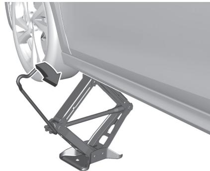
Das Fahrzeug mit korrekt ausgerichtetem Wagenheber anheben, bis das Rad vom Boden abhebt.
