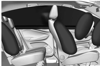
Das Airbag-System umfasst mehrere Einzelsysteme. Wenn die Airbags auslösen, werden sie innerhalb von Millisekunden aufgeblasen. Die Luft entweicht ebenso schnell, so dass dies während einer Kollision oft nicht bemerkt wird.
