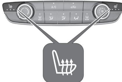
Je nach gewünschter Heizleistung, ↗ für den jeweiligen Sitz ein- oder mehrmals drücken. Die Kontrollleuchten in der Taste zeigen die Einstellungen an. Die Heizung funktioniert nur bei Außentemperaturen unter 20 °C. Für Personen mit empfindlicher Haut wird ein längerer Einsatz der höchsten Einstellung nicht empfohlen. Stopp-Start-Automatik ⇒ seite90 .
