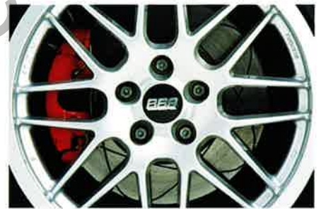
Zum sportlichen Fahren gehört eine zuverlässige Bodenhaftung durch breite Räder: BBS-Leichtmetallräder 7 1/2" x 17 mit Bereifung 215/45.
