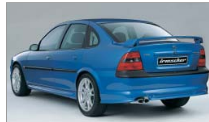
Heckschürzenlippe i 29 01 451, Heckflügel i 29 01 425 (bis Mj. 99,5), Seitenschweller (bis Mj. 99,5) i 29 01 311, Nachschalldämpfer (bis Mj. 99,5) i 29 08 041/043, Leichtmetallräder im Twin Spoke-Design.
