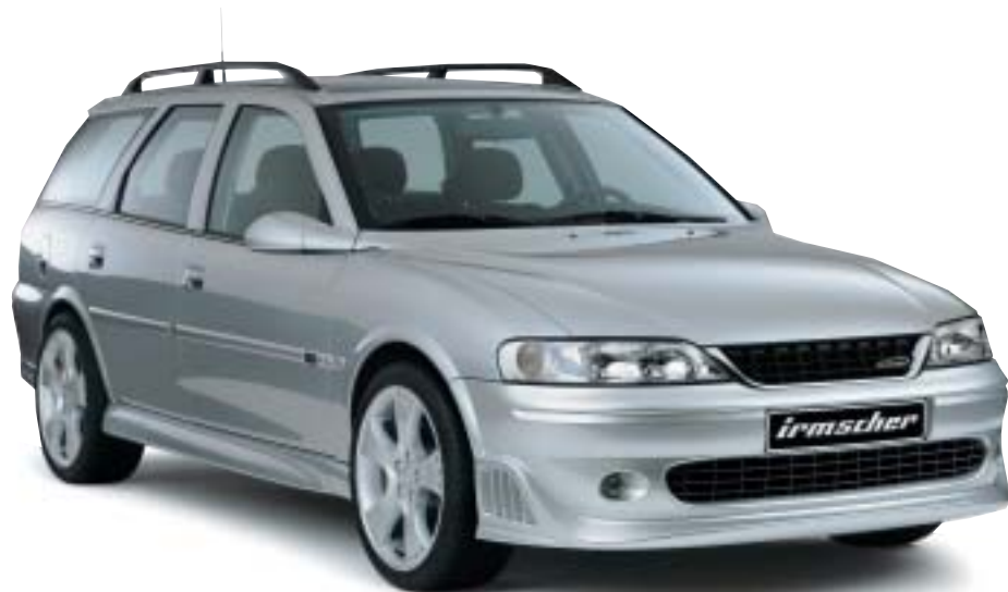
Spoilerstoßstange im STW-Look (ab Mj. 99,5) i 29 01 030, Grilleinsatz unten i 29 01 059, Kühlergrilleinsatz i 29 01 057, Seitenschweller i 29 01 0 319, Leichtmetallräder im Sport Star-Design.
