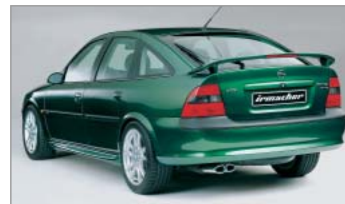
Heckflügel i 29 01 406 mit integrierter 3. Bremsleuchte (bis Mj. 99,5), Seitenschweller (bis Mj. 99,5) i 29 01 311, Nachschalldämpfer (bis Mj. 99,5) i 29 08 041/043, Leichtmetallräder im Twin Spoke-Design.
