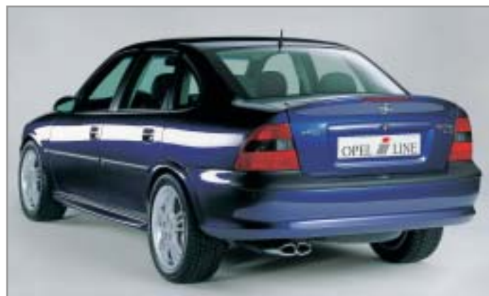
Nachschalldämpfer (bis Mj. 99,5) i 29 08 041/043, Heckspoilerlippe mit integrierter 3. Bremsleuchte (bis Mj. 99,5) i 29 01 412, Seitenschweller (bis Mj. 99,5) i 29 01 311, Leichtmetallräder im Spectra Line-Design.
