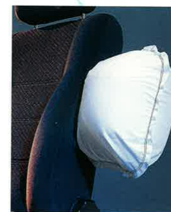
Die serienmäßigen Seitenairbags befinden sich bei jeder Sitzeinstellung immer in der idealen Schutzposition zum Fahrer bzw. Beifahrer. Die Auslösesensoren sitzen dort, von wo die meiste Gefahr droht: in den vorderen Türen.
