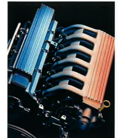
Sechs Zylinder, größte Laufhub: der Opel Turbodiesel 2.5 TD mit 96 kW (130 PS).
