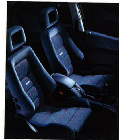
*Für beste Seitenführung beim Fahren: Recaro-Multi-Kontur-Sitze mit Lordosenstützen für Fahrer und Beifahrer mit variabler Oberschenkelauflage.*
