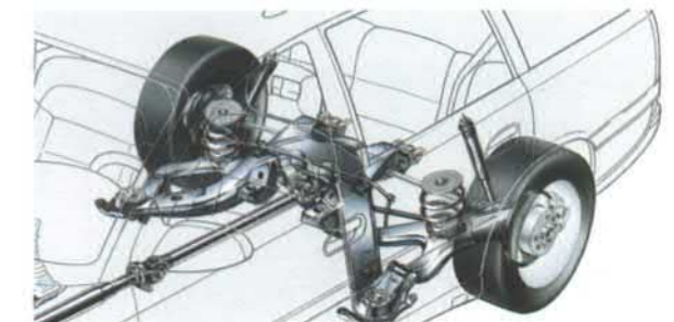
Das DSA Sicherheitsfahrwerk aller Omega Modelle erhielt unabhängig von der Motorisierungsstärke eine Multi-Link-Hinterachse und ein mehrfach entkoppeltes Differential. Mehr subjektiver Fahrkomfort durch weniger Geräuschentwicklung und präzisere Führung sind das Ergebnis.
