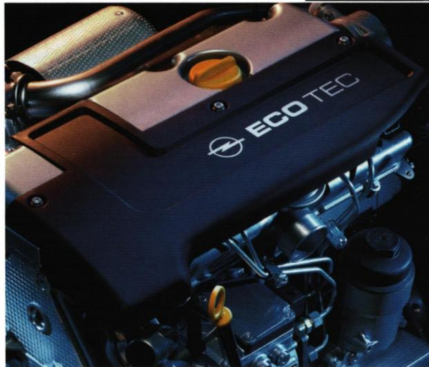
*Leicht, stark, spritzig, sparsam, wartungsarm: der 1.0 12V ECOTEC® mit drei Zylindern und 12 Ventilen im Corsa.*
