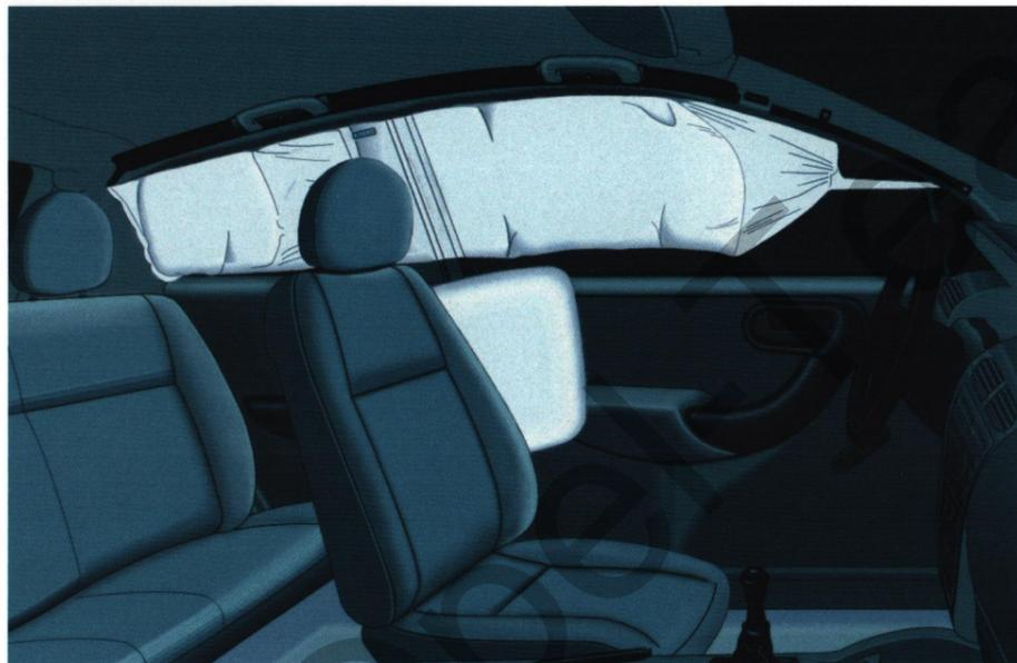
Noch besser geschützt: Bei einem Seitenaufprall entfalten sich die Full Size Kopfairbags binnen Millisekunden wie ein Vorhang vor den Seitenfenstern. So wird der Kopfbereich der außen sitzenden Passagiere abgepolstert und das Verletzungsrisiko durch Glassplitter reduziert.
