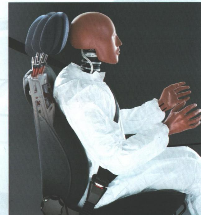
*Neueste Sicherheitstechnologie in immer mehr Opel Modellen. Aktive Kopfstützen vorn, die bei einem Heckaufprall automatisch in Richtung Hinterkopf gleiten und so die Gefahr von Nackenverletzungen verringern.*
