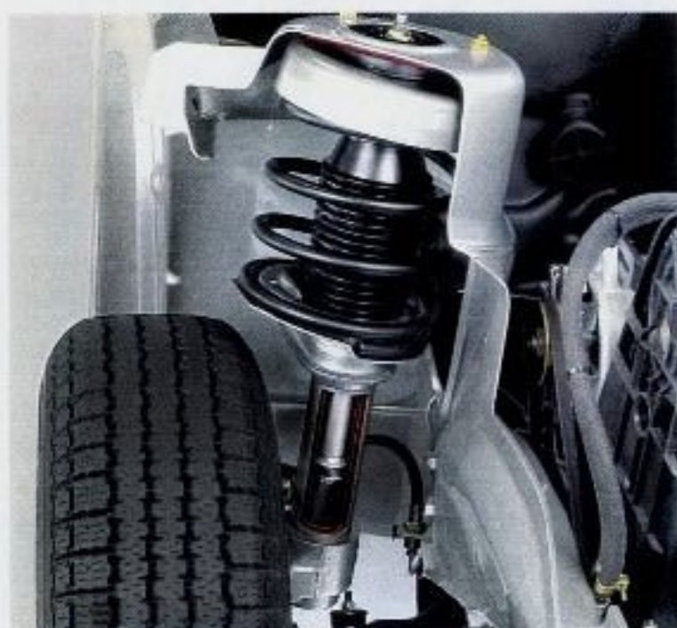
Federbeinachse vorn nach dem McPherson-Prinzip.
