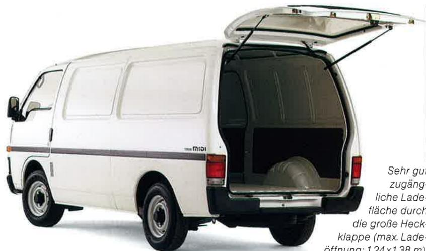
Sehr gut zugängliche Ladefläche durch die große Heckklappe (max. Ladeöffnung: 1,24 x 1,38 m).
