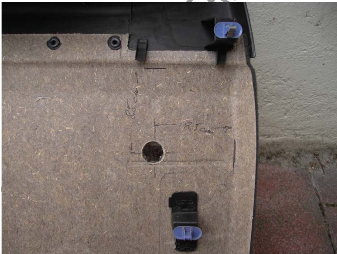
Abbildung 4: Maße für Bohrung im demontierten Zustand
