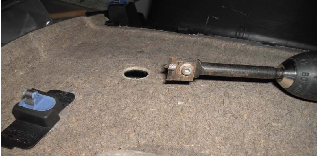
Abbildung 2: demontierte Heckverkleidung mit zusätzlicher Öffnung mittels Forstnerbohrer von der Rückseite, links
