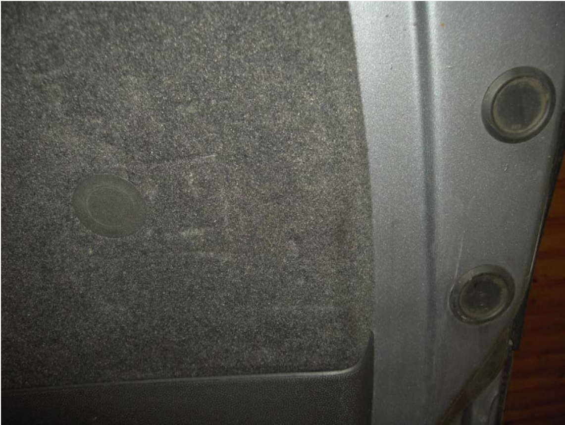
Abbildung 5: hier Blick auf die rechte Seite bei geöffneter Klappe mit zusätzlicher Bohrung und Stopfen (anthrazit)
